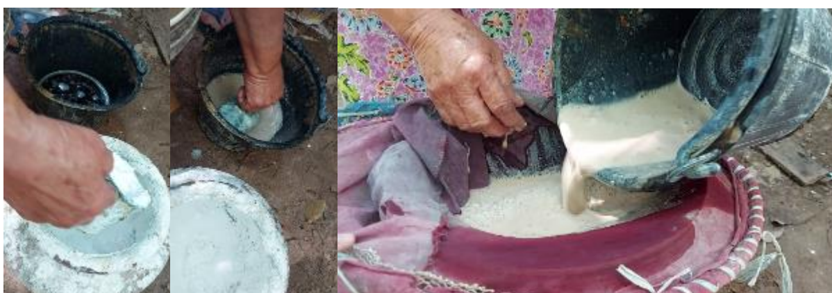
ภาพที่ 10 นำปูนขาวใสในน้ำต่างละลายให้เข้ากันแล้วกรองลงถังที่มีน้ำมะขามเปียก
