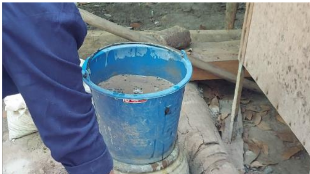
ภาพที่ 7 นำน้ำใส่ซีเมนต์แล้วกรองเอาแต่น้ำเพื่อนำมาเป็นน้ำต่าง
